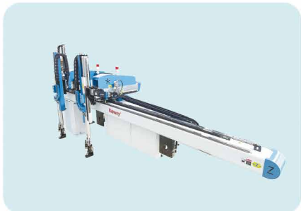
两套独立引拔+手臂共用一个横行结构 Parallel main arms injection robot
