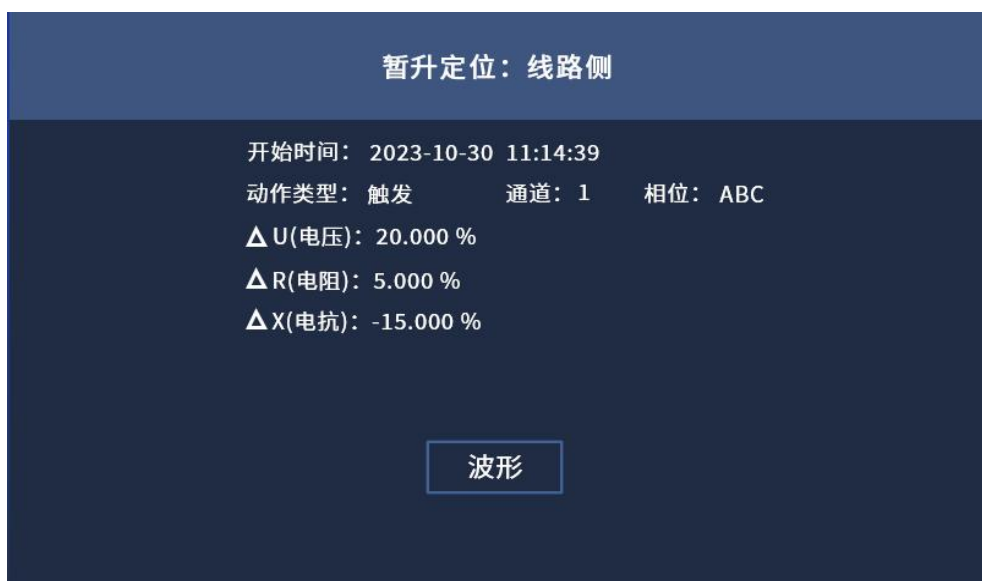
图 4.25(b) 电压暂升源定位-线路侧
