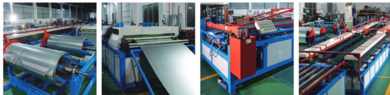
Profiles: Compatible with both 20mm & 30mm flanges. Профиль: совместим с фланцами 20 мм и 30 мм
