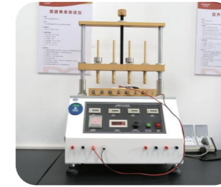
■ 按键寿命测试 Button Life Test
