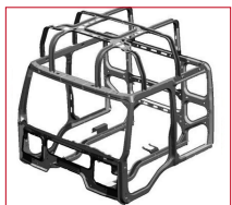
Keel Frame Cab Structure
