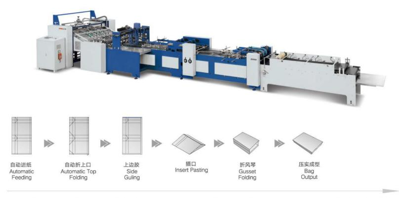
本设备是正博发明的专业型糊筒机。本设备自动进纸、折上口(嵌入式)、糊筒、折风琴,标配水溶性冷胶系统和热熔胶系统。所有上机纸张均需模切,适用 150g/m²以上纸张。调机换版速度快,生产效率高,适用于多品种小批量的产品生产。
