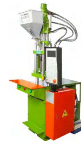
立式成型机 vertical molding machine
