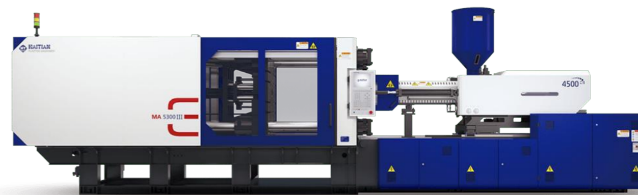
卧式成型机 Horizontal molding machine
