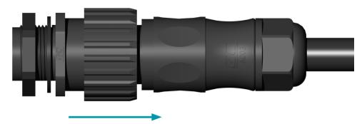
无需使用工具,先将连接帽完全拧松,再稍用力拉公插,即可完成公母插的分离。
