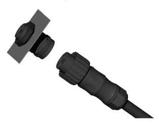
②公插和母插通过螺纹连接,拧动连接帽,会听到连续的"哒哒哒"的声音,直至连接帽的端面与母插的定位线相平齐,即为对插到位(为防止出现防水不可靠的情况,务必按照要求将公母插对插到位);
