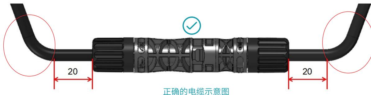
注：请参考电缆生产商的最小弯曲半径的详细要求。
